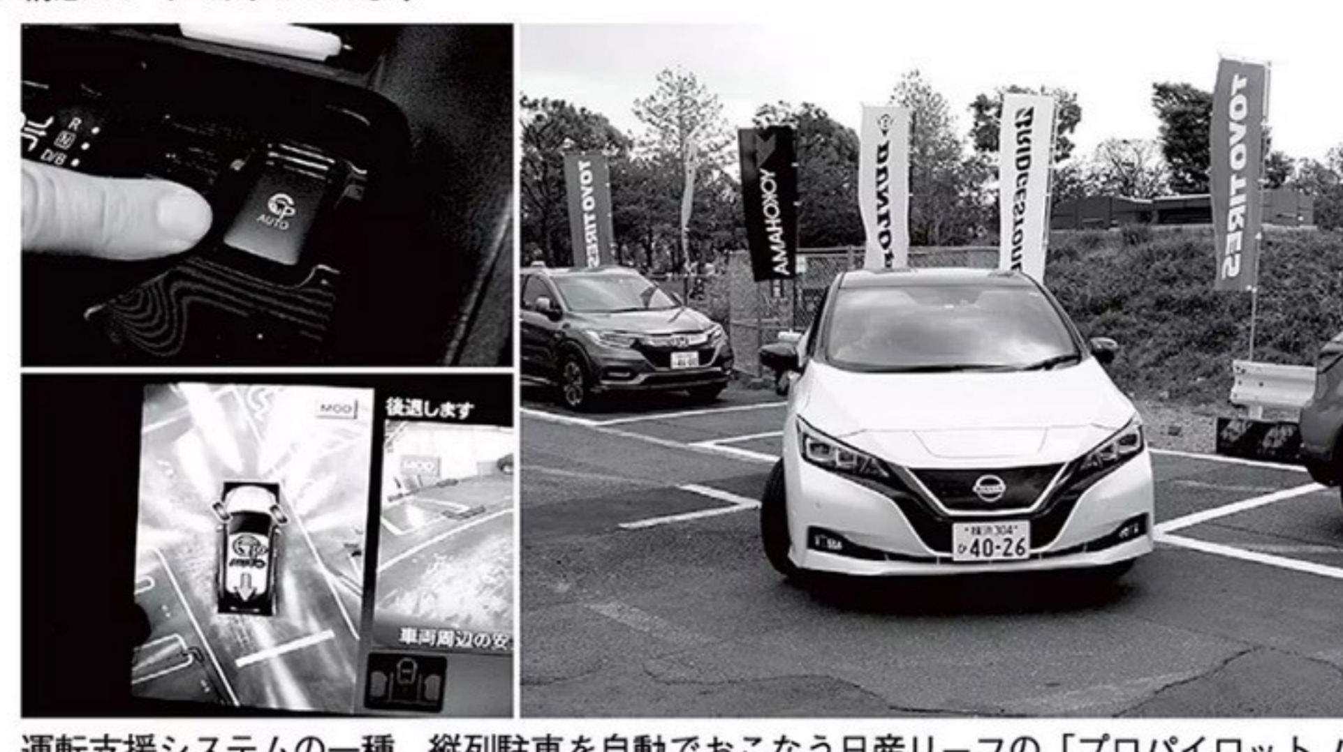
運転支援システムの一つ、縦列駐車を自動でおこなう日産リーフの「プロパイロットパークング」。大きな駐車スペースと切り返しのスペースなどを判断し、コンソールのボタン(左上)を押している限り作動し続ける。約20秒で、縦列駐車が完了
