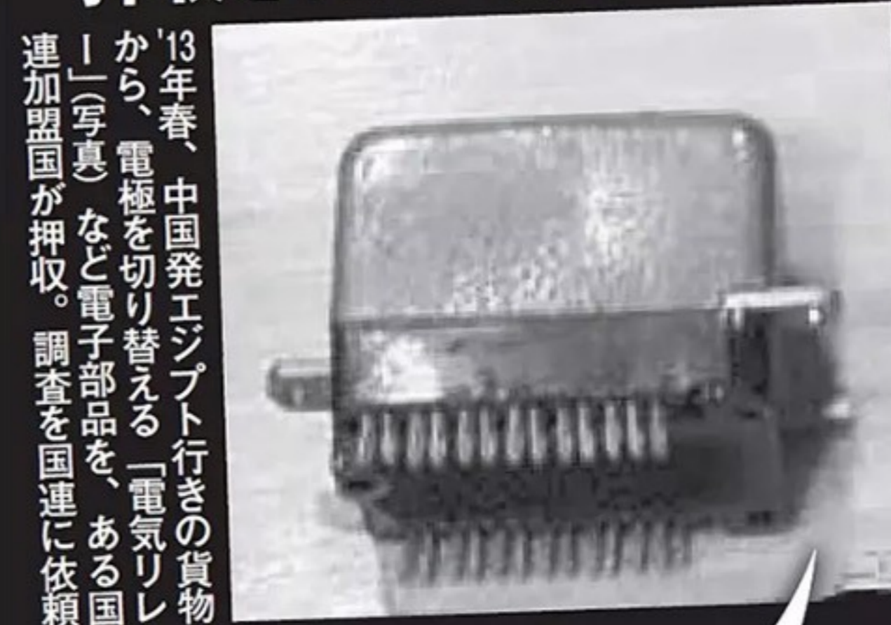
13年春、中国発エレクトロニクス製品の貨物から、電極を切り替える「電気リレー」写真など電子部品を、ある国連加盟国が押収。調査を国連に依頼
